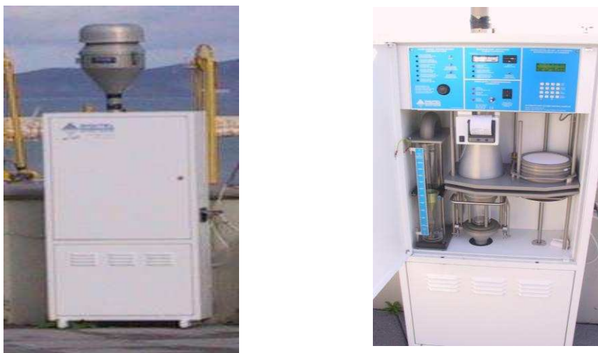
Figura 2. Fotografías (exterior e interior) del equipo de muestreo DIGITEL DHA-80.
