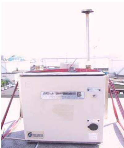
Figura 3. Fotografía y esquema de funcionamiento (cortesía de SIR S.A) del espectrómetro láser GRIMM 1107.
