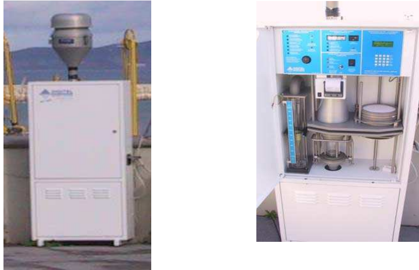
Figura 2. Fotografías (exterior e interior) del equipo de muestreo DIGITEL DHA-80.
