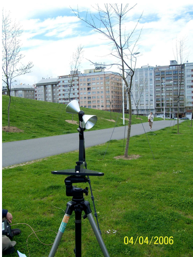
Foto4. Sistema de medida en banda estrecha con antena bicónica (80 MHz - 2500MHz). Parque Eiris frente calle Oleoducto
