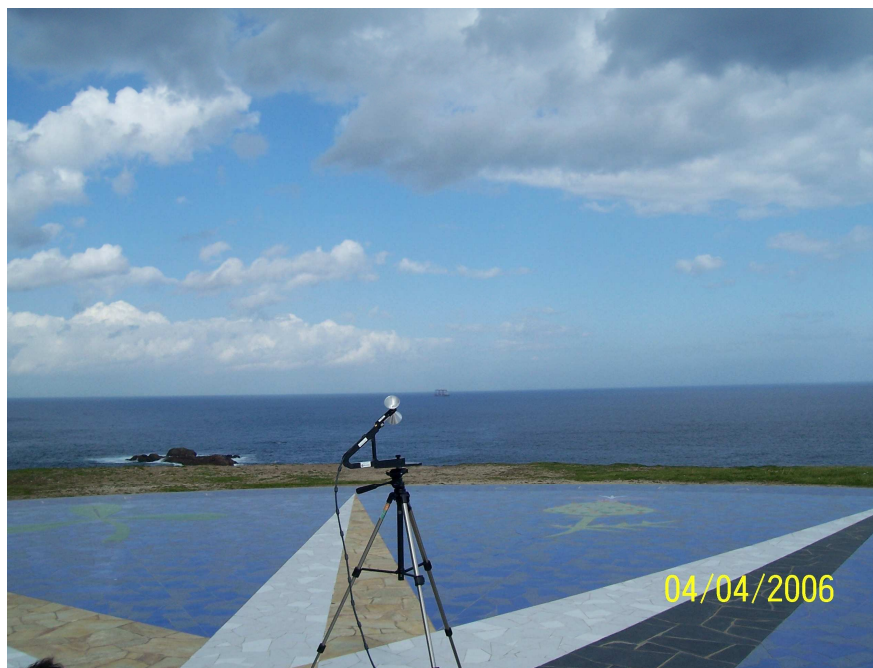
Foto4. Sistema de medida en banda estrecha con antena bicónica (80 MHz - 2500MHz). Parque Eiris frente calle Oleoducto
