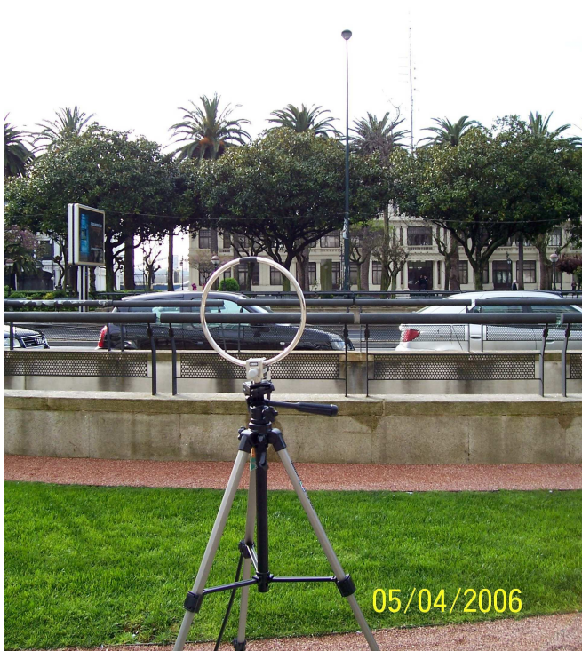
Foto 5. Sistema de medida mediante antena loop (50 KHz- 30 MHz). Torre de Hércules Rosa de los Vientos
