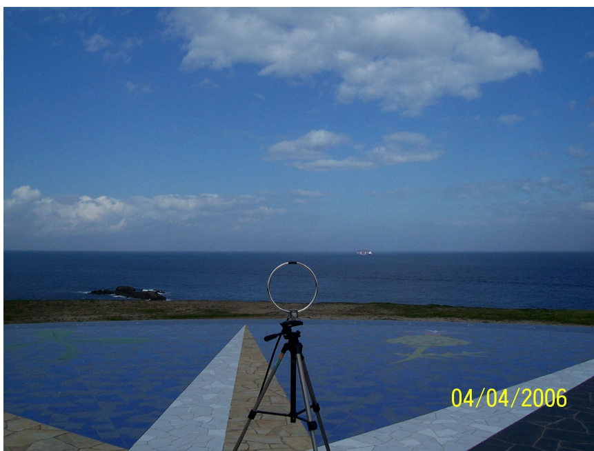
Foto 5. Sistema de medida mediante antena loop (50 KHz- 30 MHz). Torre de Hércules Rosa de los Vientos
