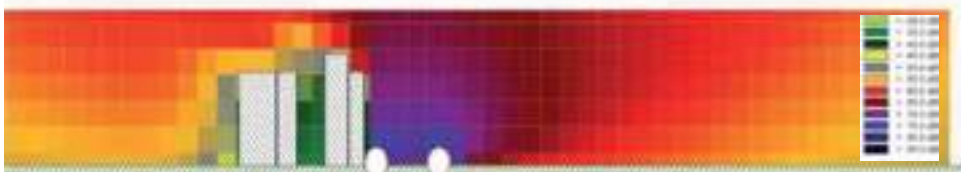
Figura 5.3: Disipación energética del ruido: sección transversal de la intensidad sonora que producen dos carriles de tráfico rodado en zona semiurbana. Fuente: BCNecología.
